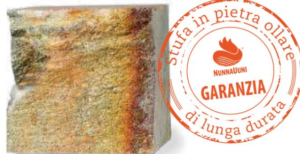
Lo strato di periclasio che riveste la superficie della pietra ollare Mammutti garantisce la durezza della camera di combustione.
